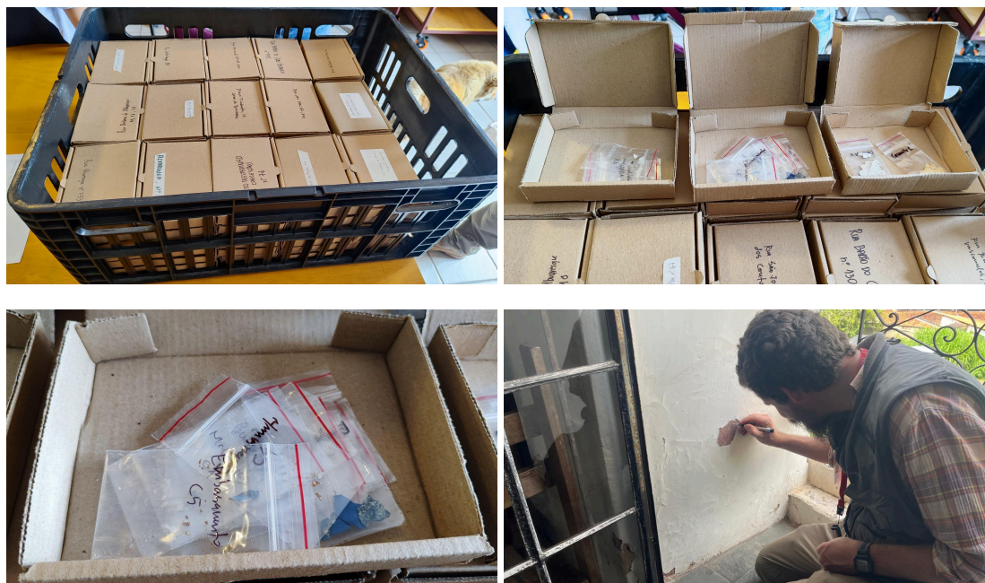
Fragmentos de camadas pictóricas extraídos do casario de Ouro Preto para análise e catalogação
