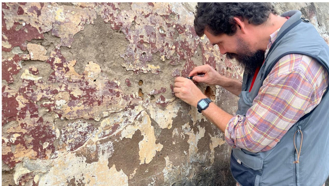
Retirada de fragmentos das camadas pictóricas para análise e documentação
